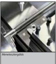
Az SPA-500P eszterga orsójának minden mozgó alkatrésze olajfürdőben forog.
